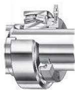
Figura 4. Ghiera HMV per far avanzare il cuscinetto su una bussola di trazione
