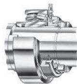
Figura 8. Ghiera HMV ed anello di bloccaggio in posizione per sbloccare una bussola di trazione
