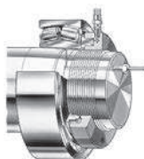
Bild 3. Einbau eines Lagers direkt auf kegeligem Sitz
