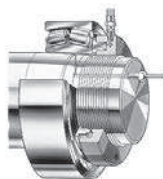
Figura 3. Ghiera HMV per far avanzare il cuscinetto su una sede conica
