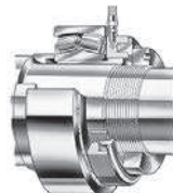
Bild 6. Einpressen einer Abziehhülse in ein Lager mit einer auf dem Hülsengewinde montierten Hydraulikmutter, die gegen einen Anschlag auf der Welle abgestützt ist
