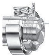
图3. HMV液压螺母将轴承推进到锥轴固定位置
