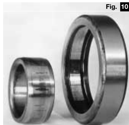
Fig. 10 Bague intérieure et bague extérieure d'un roulement à rouleaux cylindriques soumis à des vibrations
