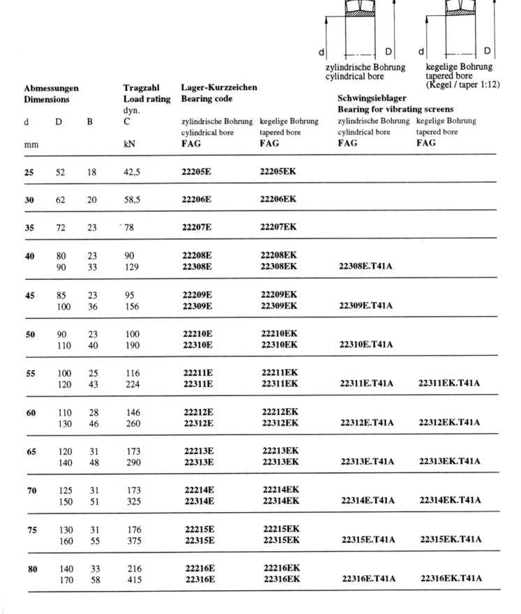
FAG Pendelrollenlager E mit Stahlblechkäfig FAG E-design spherical roller bearings with pressed steel cages
