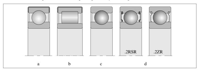
Stromisolierte FAG Rillenkugellager in bevorzugt lieferbaren Ausführungen
