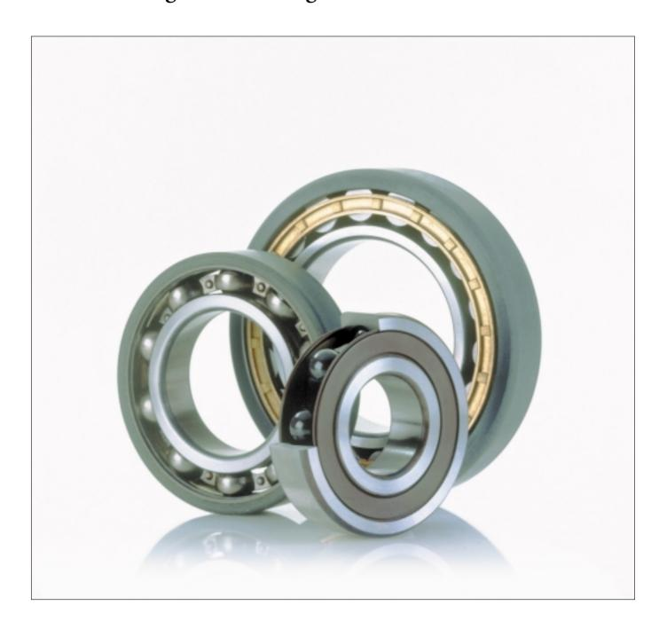
An den Lagern von Elektromotoren können unter ungünstigen Bedingungen Stromdurchgangsschäden auftreten. Magnetische Unsymmetrien, die auch bei sorgfältiger Fertigung der Motoren nicht ganz vermieden werden können, rufen ein Spannungsgefälle zwischen Rotor und Stator hervor. Der Stromkreis schließt sich über die Lager. Besonders gefährdet sind Wälzlager in Elektromotoren, die mit einer Umrichtereinspeisung betrieben werden.
